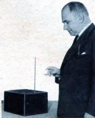
Abb. 6. Die Veränderung der Abstimmung geschieht bei dem fogen. Thorem-Gerät durch Annäherung der Hand an einen Metallstab.
