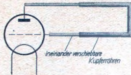
Abb. 12. Abstimmung durch ausziehbare Kupferrohre.
